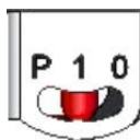
Rysunek 20: Ustawienie przełącznika wł./wył./P w położeniu włączenia
