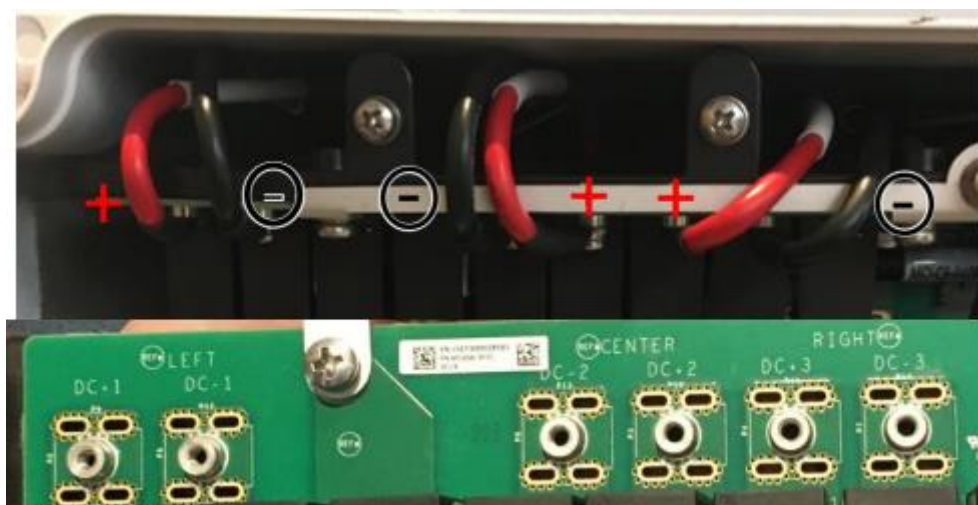
Rysunek 18: Zachowanie odpowiedniej biegunowości
