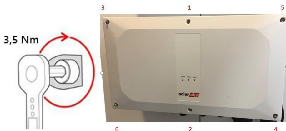
Rysunek 19: Kolejność dokręcania śrub
