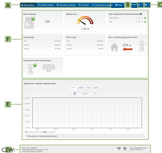
Ilustracja 14: Struktura strony startowej interfejsu użytkownika (przykład)
