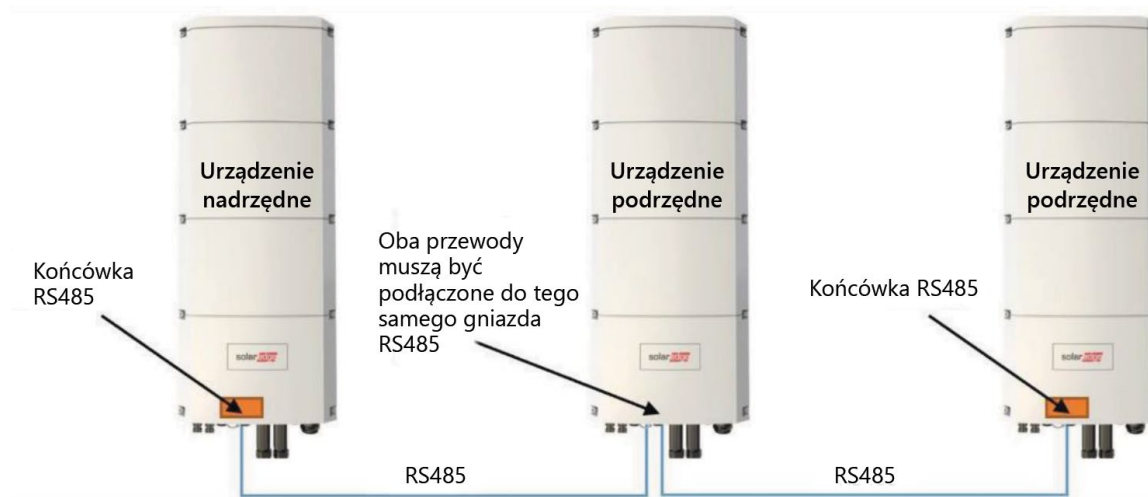
Ilustracja 2 Komunikacja przewodowa pomiędzy falownikami
